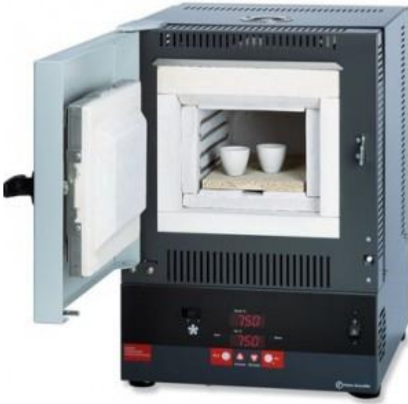
Figura 10: Horno de mufla utilizado en laboratorio para llevar a cabo el método LOI.
