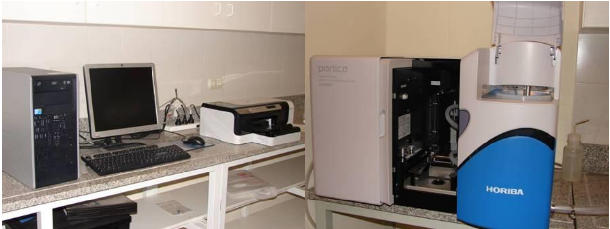
Figura 9: Analizador de partículas por difracción computarizado utilizado en laboratorio.
