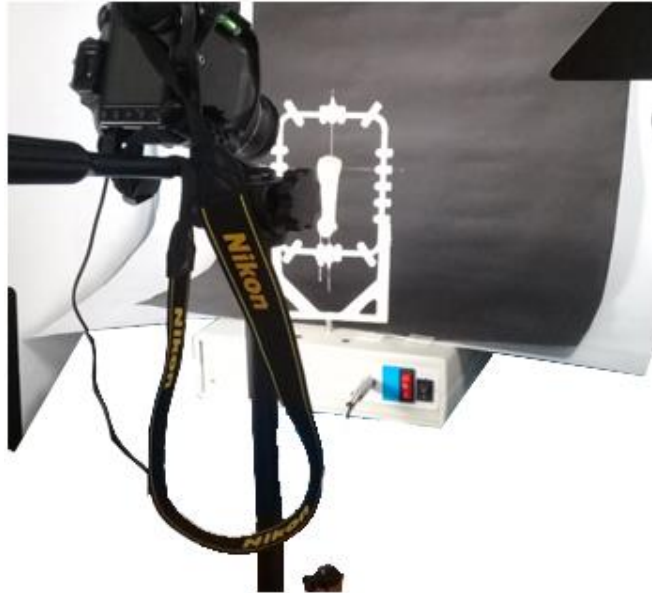
Figura 17. Sistema de motor paso a paso y cámaras fotográficas, con el control de disparo automático.
