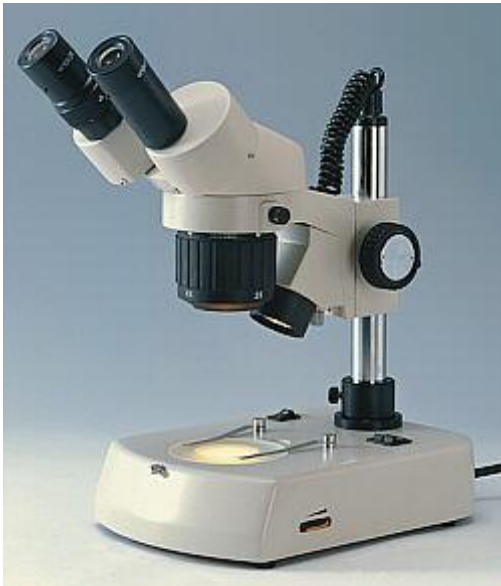
Figura 4.5.2.1: Lupa Estereoscópica Binocular Motic, con la que se realizarán las primeras observaciones (entre 20 y 40 aumentos) de la modificación del filo activo de los instrumentos por el uso (redondeamientos, microestallamientos, etc.).
