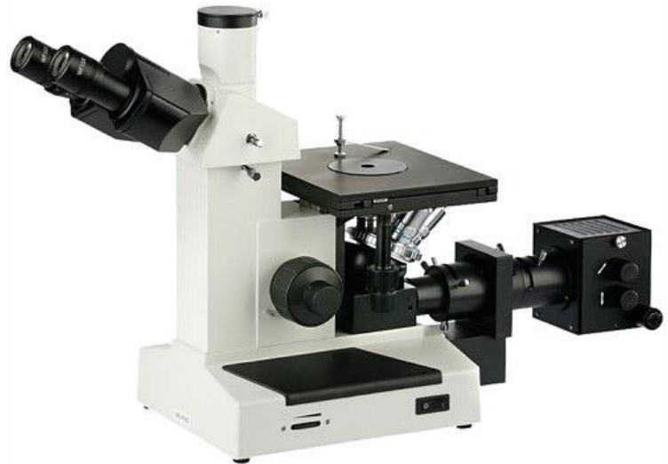
Figura 4.5.2.2: Microscopio Metalográfico Invertido Motic, con el que se profundizarán las observaciones (generalmente a 200 aumentos) de las modificaciones del filo activo (estallamientos, inicios de micropulidos, etc.)
